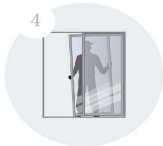
新規ガラス障子 吊り込み・作動調整
