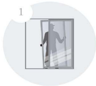
現状ガラス障子撤去
