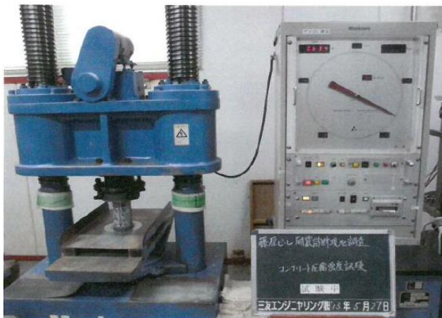
圧縮強度試験
