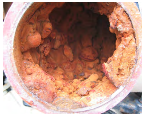
水配管用亜鉛めっき鋼管 (当時の名称: 水道用亜鉛めっき鋼管)
