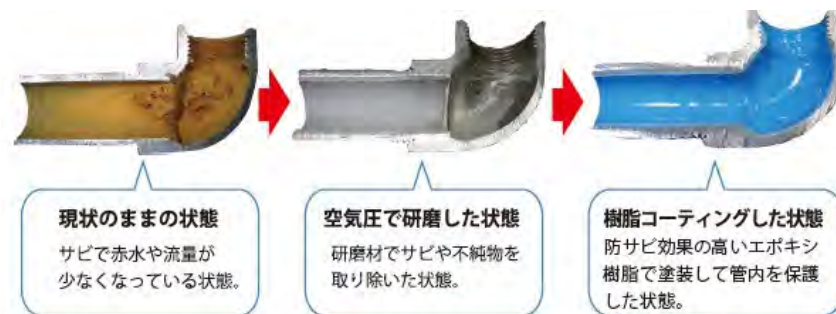
給水管ライニング更生工事の例
