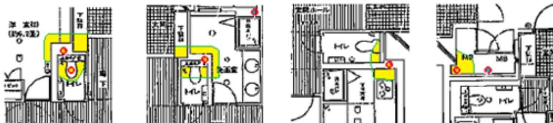
図 2-2-5 住戸内の排水設備の点検箇所の例（黄色の部分に滲みがでてこないか確認）
