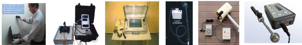
写真 現在開発されている外壁診断装置 (手動) の例 (「湿式外壁等の定期調査方法の合理化の検討」報告書より)
